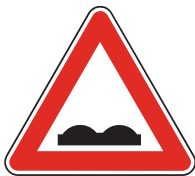
A 5 Nerovnosť vozovky
