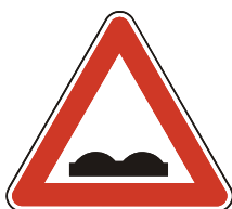
A 5 Nerovnosť vozovky
