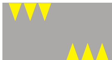
Z 6b Stavebný spomaľovací prah (označenie)
