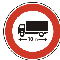
B 20 Zákaz vjazdu vozidiel alebo súprav vozidiel, ktorých dĺžka presahuje vyznačenú hranicu (vzor)
