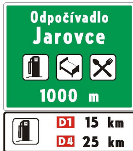
II 18a Odpočívadlo s objektmi služieb (vzor)
