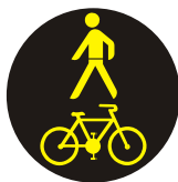
S 11d Doplnkový signál s prerušovaným žltým svetlom v tvare chodca a cyklistu
