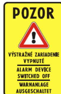
IP 30a Výstražné zariadenie vypnuté
