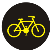
S 11c Doplnkový signál s prerušovaným žltým svetlom v tvare cyklistu
