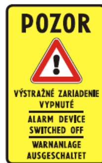
IP 30a Výstražné zariadenie vypnuté
